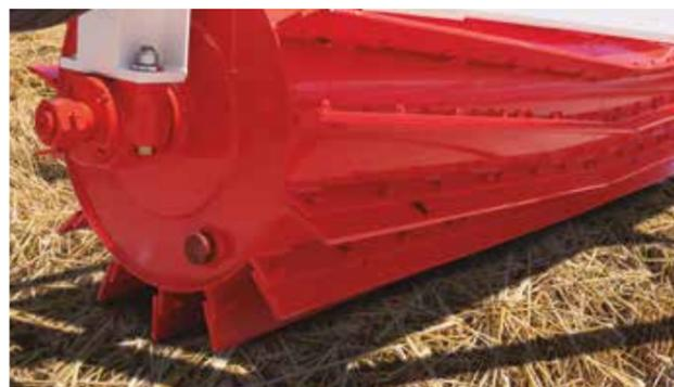
**Cuchillas con filos ondulados:** Los rolos están equipados con cuchillas de filo ondulado (diseño exclusivo de Distrimaq, patentado) que proporcionan mayor corte con menor presión y gran capacidad de auto afilado con el uso. En todo tipo de lote y rastrojo.
